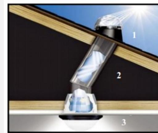
Fig 06 : Les composants d'un conduit de lumière. Source: ww.pining.com
