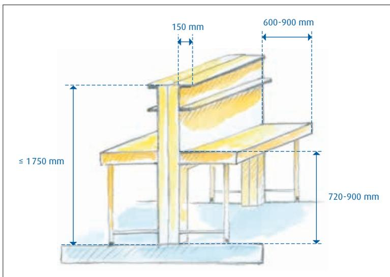
Figure 20. Dimensions des paillasses de laboratoire.
