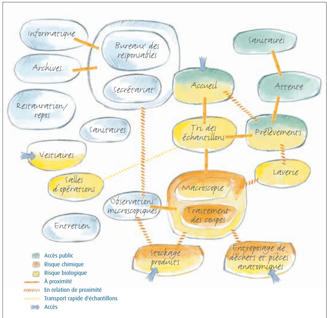
Figure 46. Schéma fonctionnel d'un laboratoire d'anatomie et de cytologie pathologiques.
