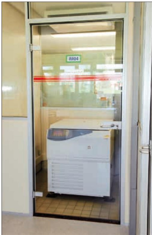
Figure 18. Les appareils bruyants, tels que les centrifugeuses, peuvent être placés dans des salles isolées.
