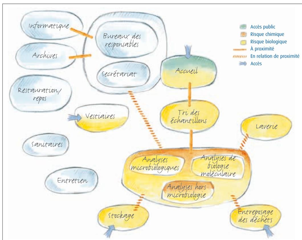
Figure 69. Schéma fonctionnel d'un laboratoire d'analyses industrielles.
