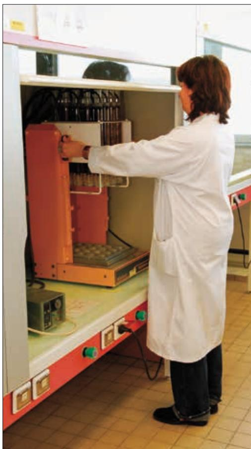
Figure 73. La hauteur de paillasse doit être adaptée aux automates devant rester accessibles au personnel.
