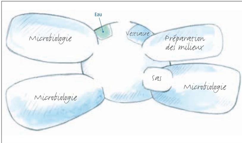
Figure 26. Schéma fonctionnel de plusieurs salles de microbiologie.
