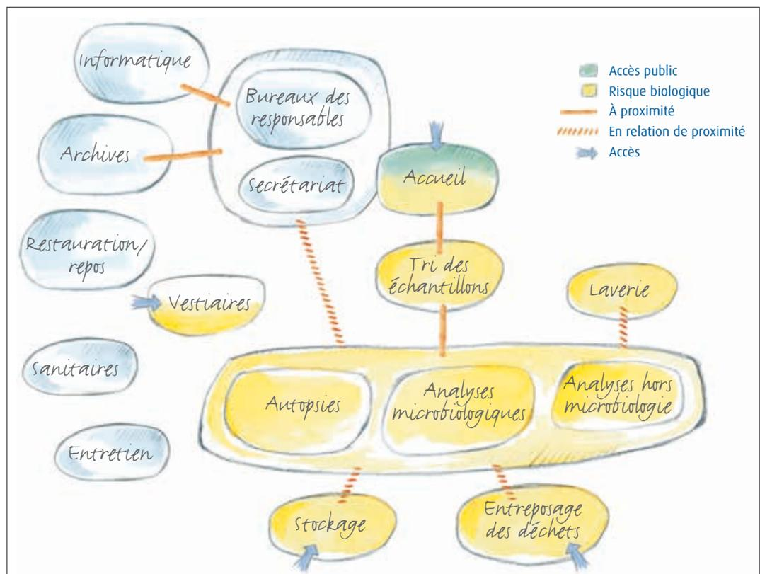
Figure 61. Schéma fonctionnel d'un laboratoire d'analyses vétérinaires.
