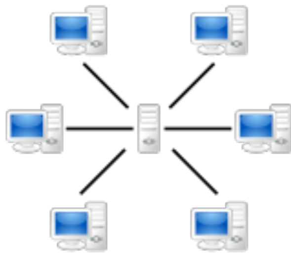
Architecture centralisée (client-serveur en étoile)
