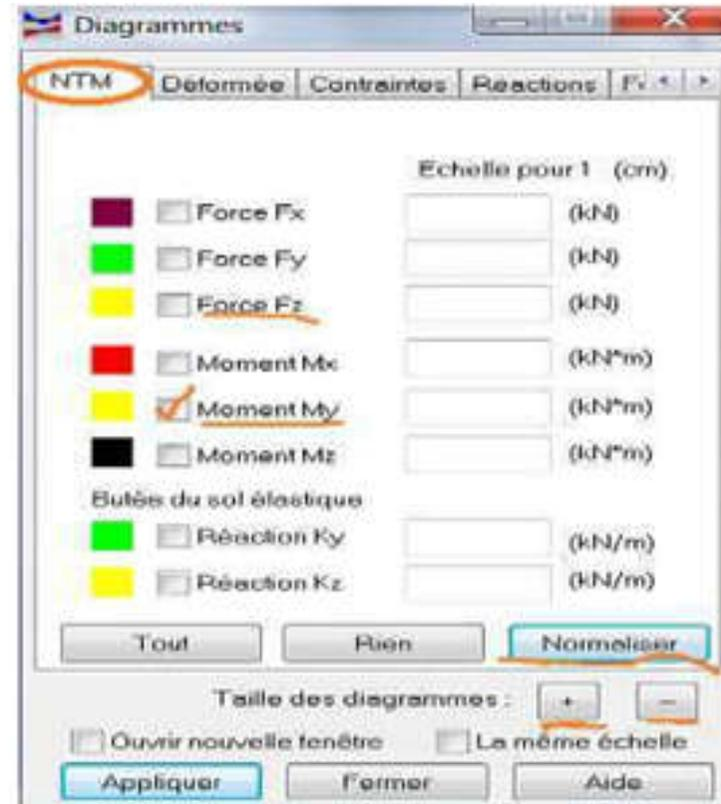
On peut voir les diagrammes des efforts internes et des déplacements de chaque élément de la structure séparément en cliquant sur la barre par le bouton droite de la souris et on clique **Propriétés de l'objet**.
