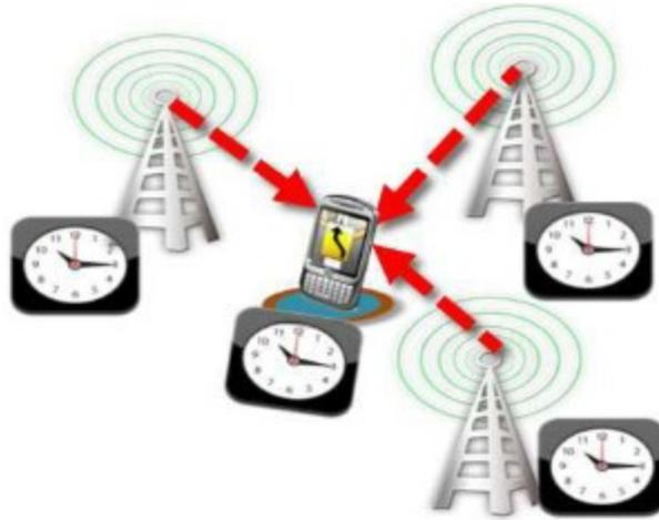
Principe du positionnement endogène.
