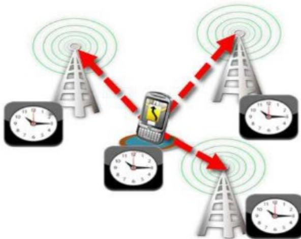
Principe du positionnement exogène.
