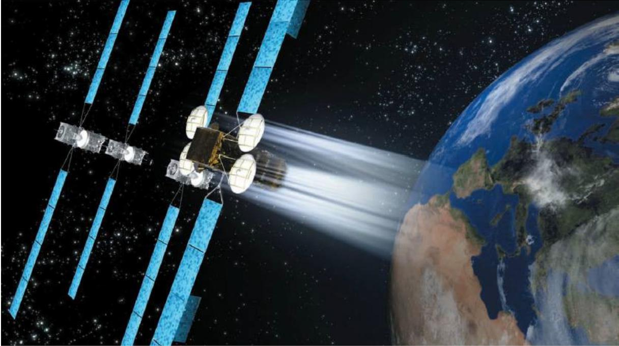
La structure d'une liaison par satellite est semblable à celle d'un faisceau hertzien terrestre à deux bords, le satellite jouant le rôle de station relais.
