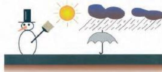
Assurer la protection de l'arase terrassement vis à vis des agents climatiques dans l'attente de la réalisation de la chaussée.
