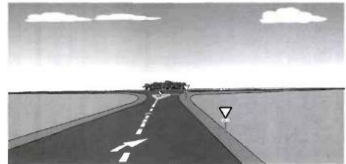
Fig. 7 — Ecran végétal en blocage de la vision sur la branche secondaire d'un carrefour en té.
