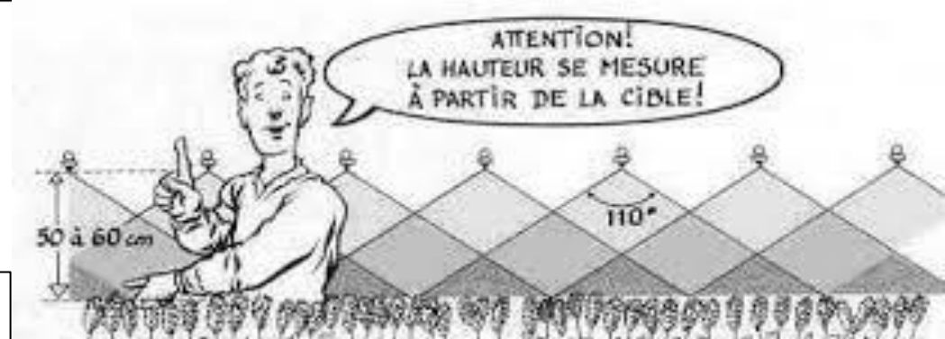
Angle d'ouverture des buses
