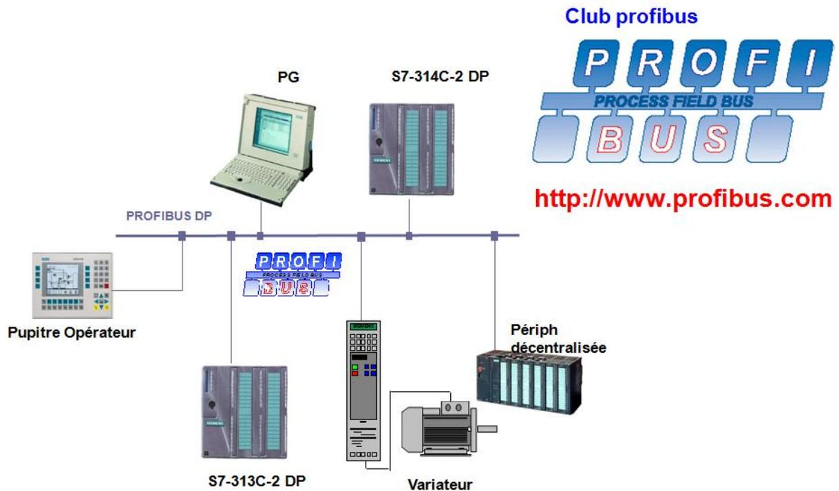
**Figure : Domaines d'utilisation de Profibus**
