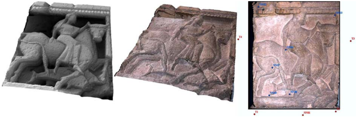
Figure 2-34 : "Europe montant le taureau" : du modèle numérique à l'ortho-photo en passant par l'image raster [DAM05].
