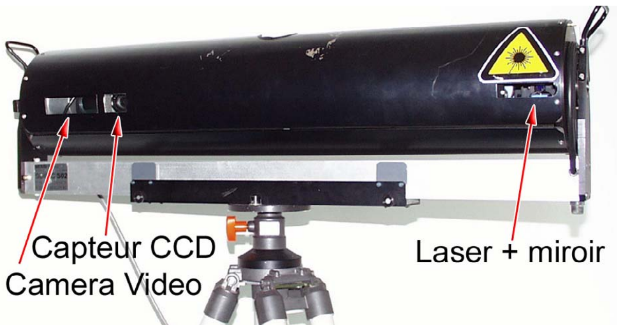
Figure 2-9 : le capteur « SOISIC » de MENSI.
