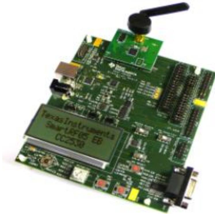
Appuyez à droite du joystick sur l'appareil. Cela permettra au périphérique d'accepter les demandes de liaison et de configurer ce nœud comme nœud de passerelle. La LED 2 sera allumée.
