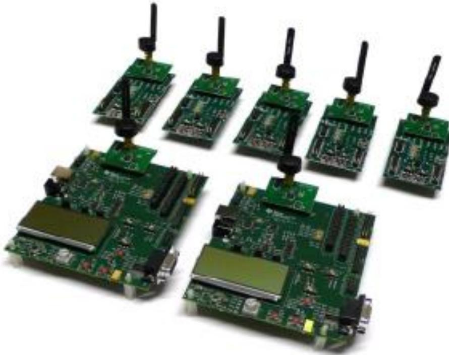
Sur les cartes EB, placez le cavalier P11 en position pour l'alimentation de la batterie. Placez le commutateur de sélection EM sur chacun des EB et BB en position SoC / TRX.
